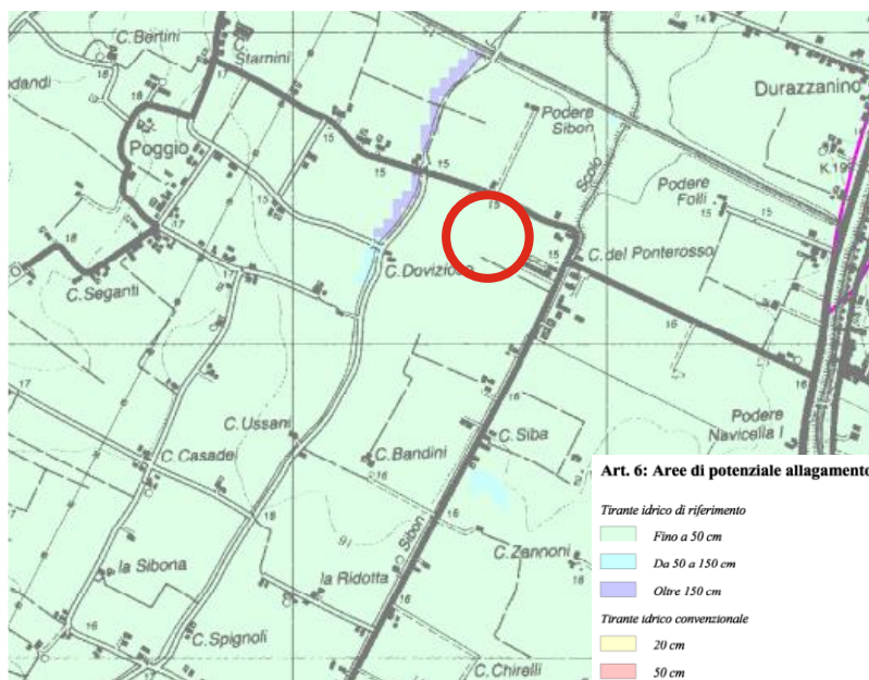
Figura 20. Carta Tiranti Idrici di Riferimento per le Aree di Pianura Sottoposte a Rischio di Allagamento
